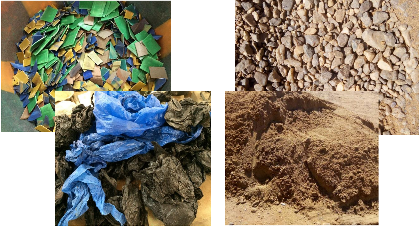
Figure 6: Sélection des matières premières pour le développement du béton/mortier (MPB/PWC)
