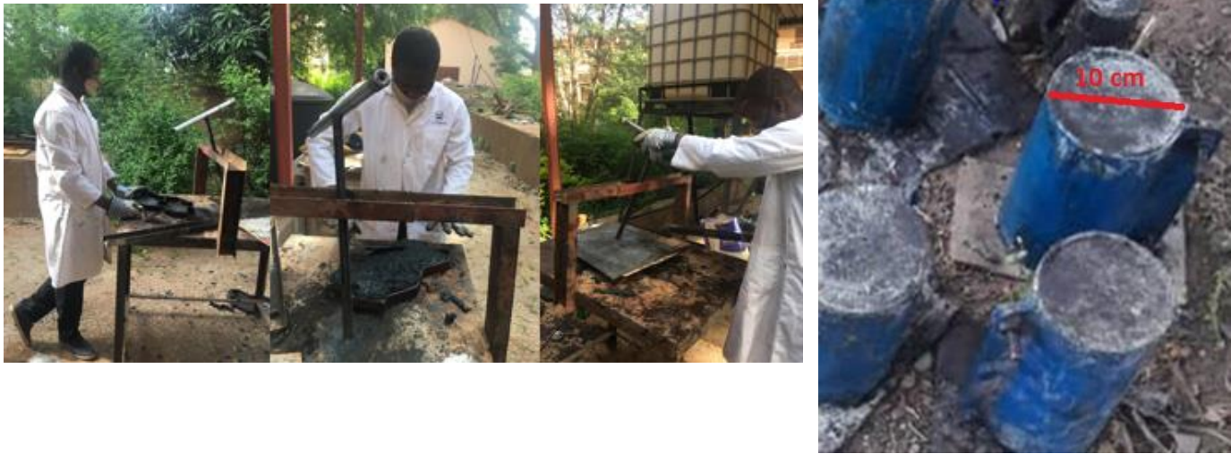
Figure 14: Echantillons des pavés avec les nouveaux matériaux dans les moules a) avant et b) après compaction avec la presse manuelle.
